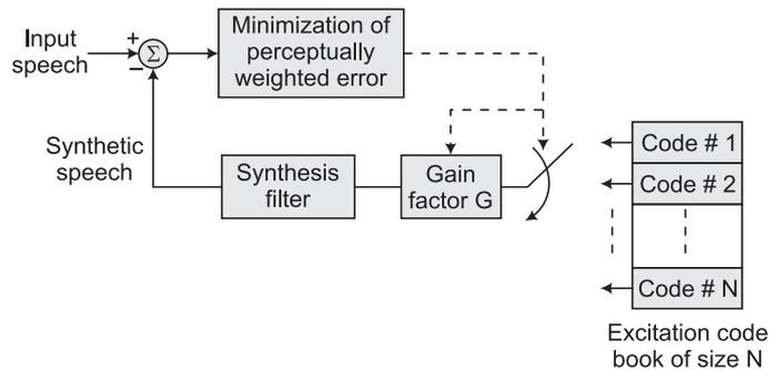
**FIG. 9 ENCODER OF THE CODE-EXCITED LINEAR PREDICTIVE CODEC (CELP)**
