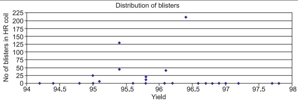
**FIG. 8 OCCURRENCE OF BLISTERS IN SCARFED SLABS**
