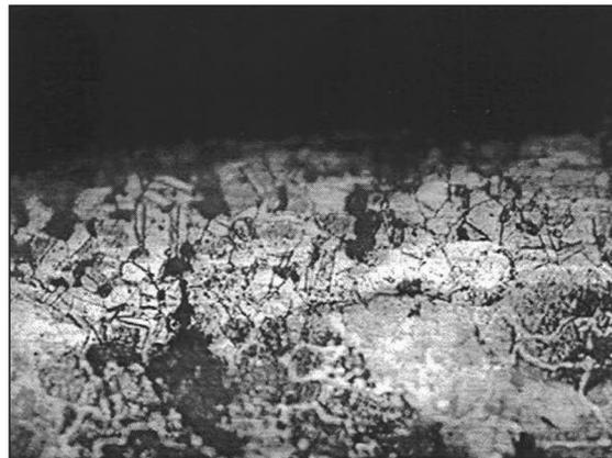
**PHOTOGRAPH 8 MICROSTRUCTURE ACROSS THE WALL OF THE BOWED TUBE AT THE OUTSIDE SURFACE NEAR THE MAXIMUM BOW POSITION (200X)**
