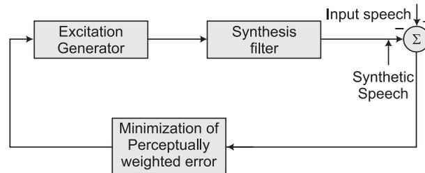
**FIG. 7 MULTI-PULSE EXCITED LINEAR PREDICTIVE ENCODER**
