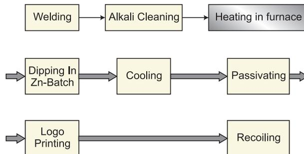
**FIG. 4 SCHEMATIC LINE LAYOUT OF CGL#1**
