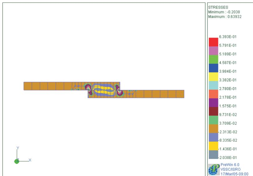
FIG. 6(b) NORMAL STRESS DISTRIBUTION OF THE LAP JOINT
