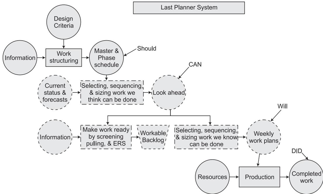
**FIG. 2 PROCESS OF LAST PLANNER SYSTEM™**
