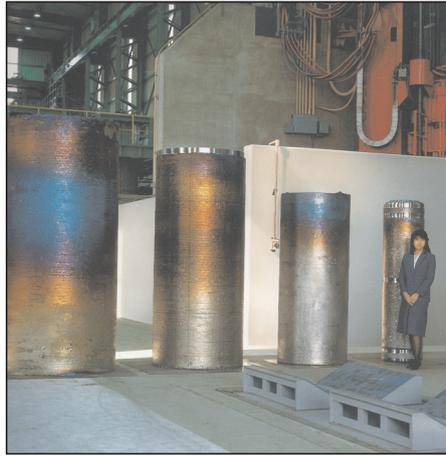
**FIG. 1 TITANIUM INGOTS OF VARIOUS SIZES**
