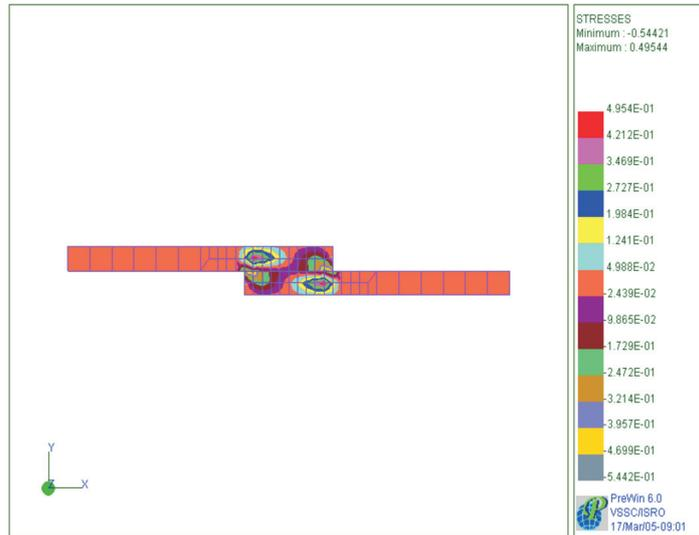
FIG. 6(a) SHEAR STRESS DISTRIBUTION OF THE LAP JOINT
