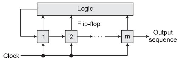
FIG. 1 FEEDBACK SHIFT REGISTER
