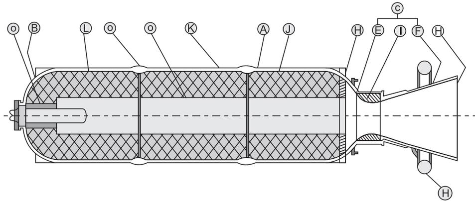
**FIG. 5 CROSS-SECTION OF A TYPICAL CASE-BONDED SOLID ROCKET MOTOR**
