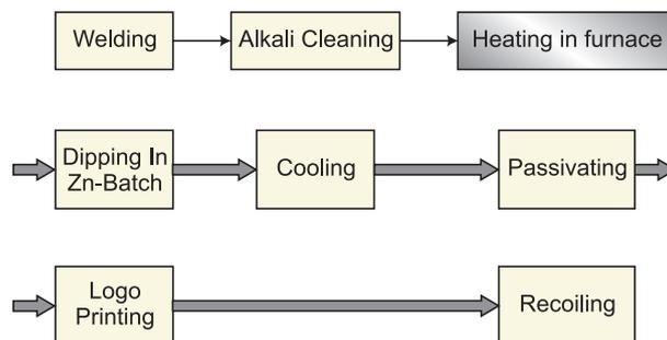
**FIG. 4 SCHEMATIC LINE LAYOUT OF CGL#1**
