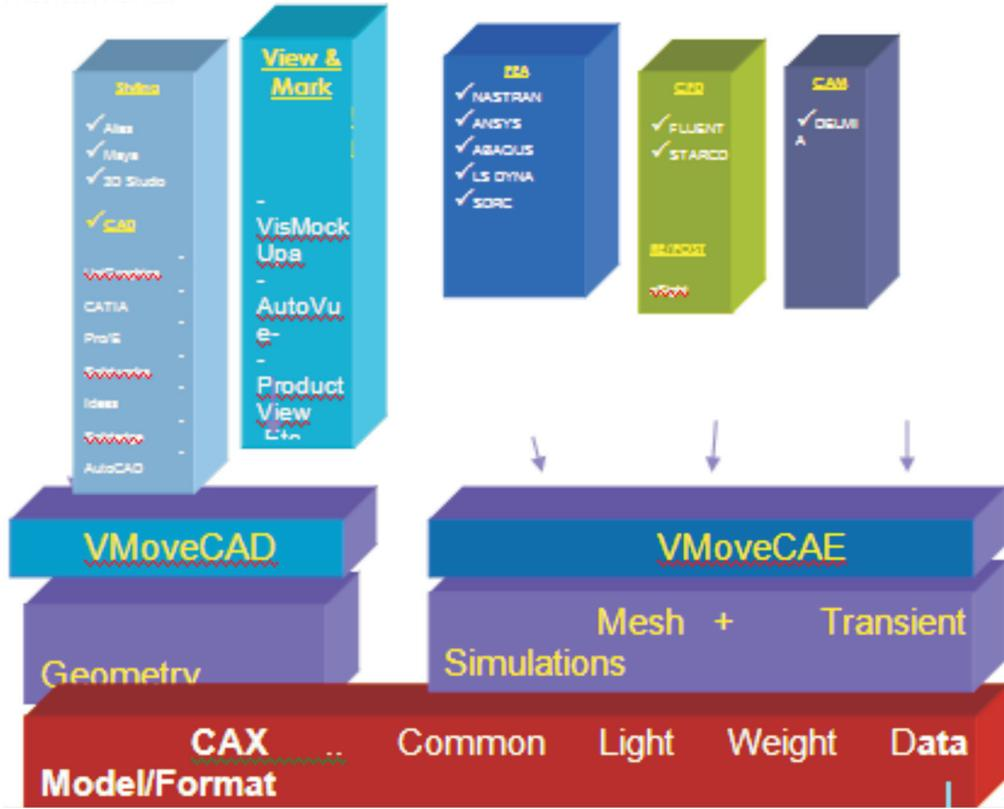
FIG. 12 GENERATION OF A COMMON LIGHTWEIGHT DATA MODEL FOR CAE DATA. (CAX FORMAT)
