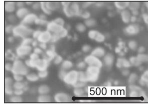
**FIG. 4 A TYPICAL SEM OF NANO-SILICA PARTICLES (REF 2)**
