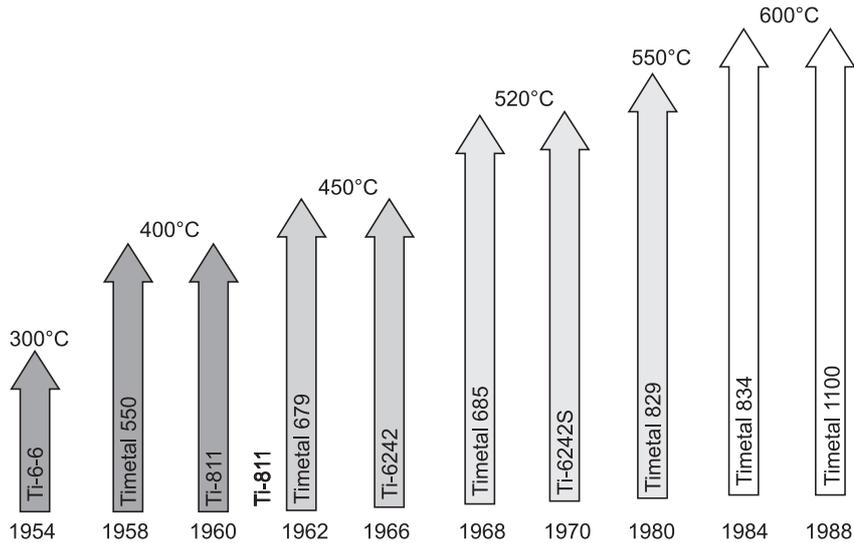
**FIG. 3 INCREASE OF MAXIMUM APPLICATION TEMPERATURE OF TITANIUM ALLOYS**
