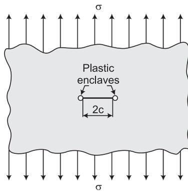
**FIG. 4 PLASTIC REGION AROUND CRACK-TIP**
