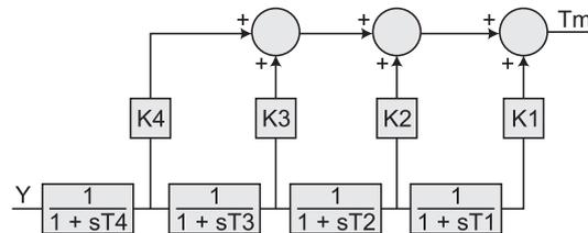
**FIG. 6 BLOCK DIAGRAM OF STEAM TURBINE MODEL**
