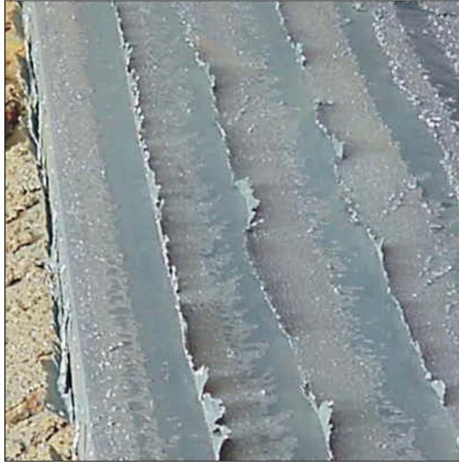
**FIG. 4 A STICKY SCALES ON SCARFED SLABS**
