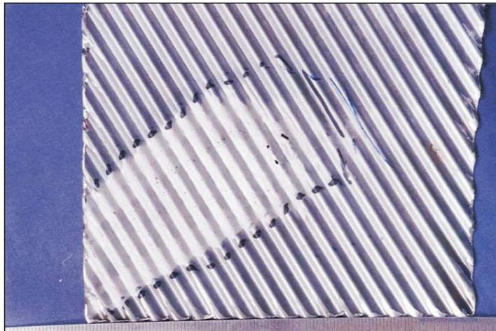
**PHOTOGRAPH 11 SHARP HOLES AND CORROSIVE ATTACK DOWNSTREAM OF THE HOLES ON THE ACID SIDE**
