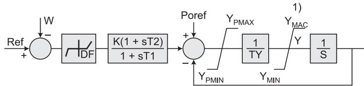
**FIG. 5 BLOCK DIAGRAM OF STEAM GOVERNOR MODEL**
